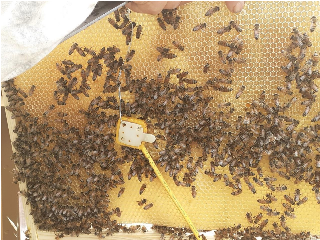
Fig. 19 - Posizione definitiva del sensore a circa metà altezza su un favo centrale
