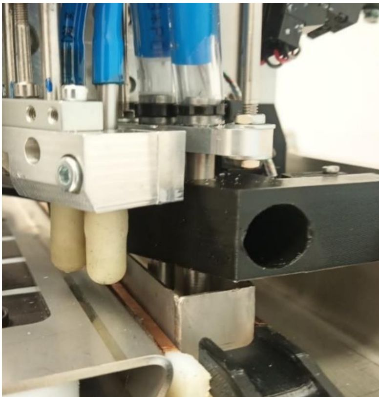
Fig. 75 - Particolare operazione di lavaggio ugelli
