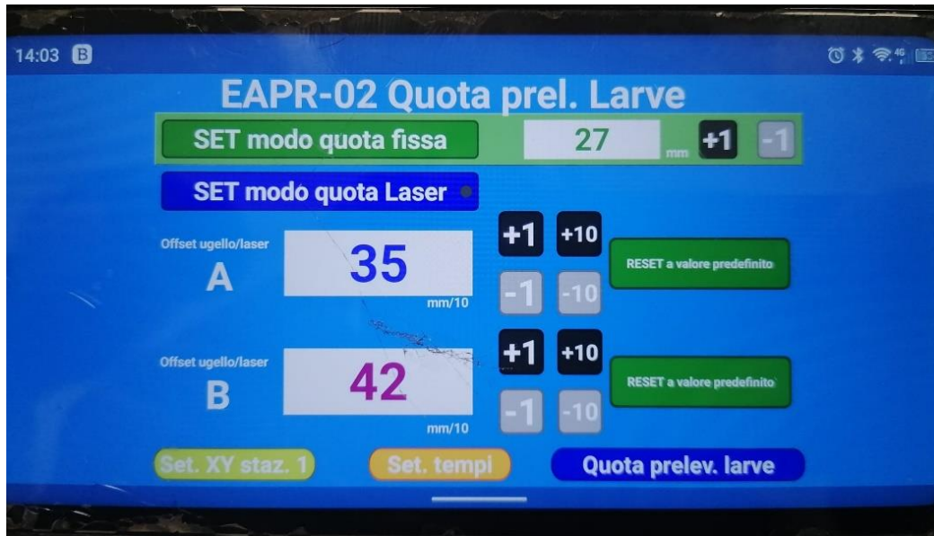
Fig. 59 - Schermata app bluetooth da smartphone per settaggio offset altezza di prelevamento larve
