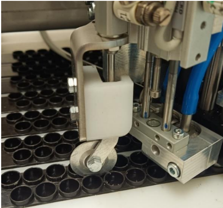
Fig. 74 - Particolare sistema di blocco attivo stecche posizione interfilare
